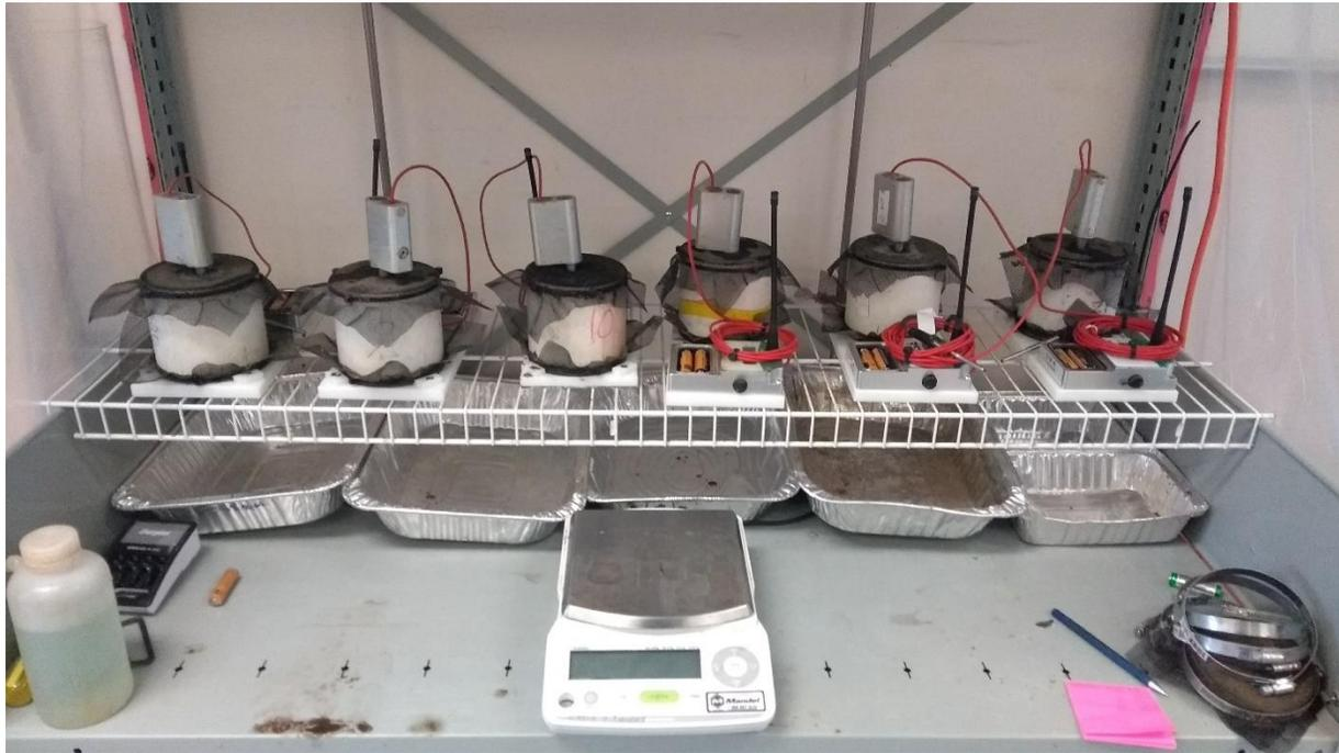
Figure 67 : Installation en laboratoire pour déterminer les courbes de désorption en eau du sol – Complexe scientifique de Québec.
