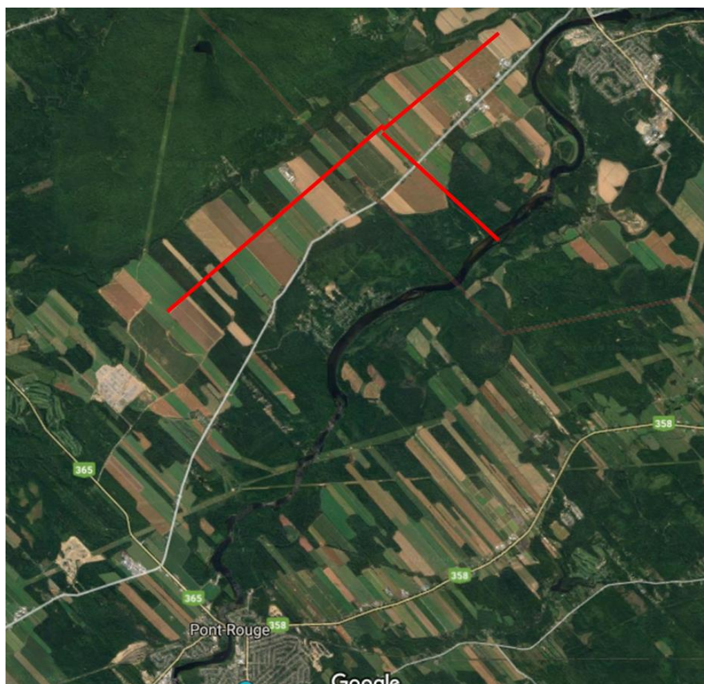
Figure 9.10 Représentation schématique du réseau d'aqueduc permettant d'amener l'eau sous pression jusqu'aux champs de pommes de terre.
