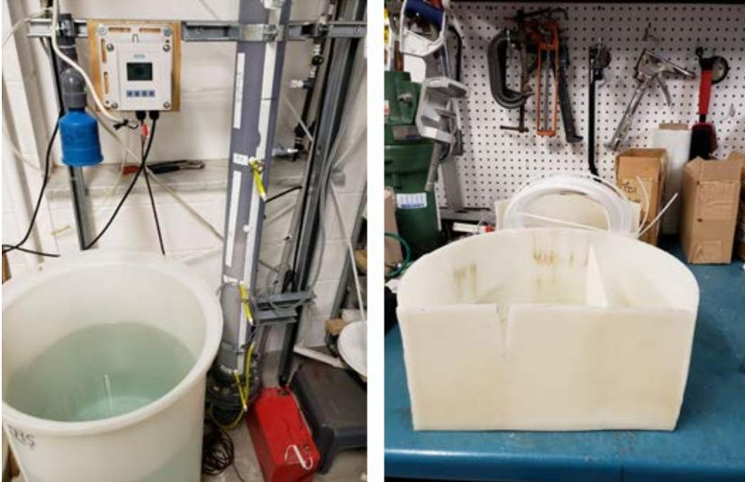
Figure 6 : Test de l'appareil de mesure au laboratoire du CREDEAU, Polytechnique (gauche) - Boîte déversoir (droite).
