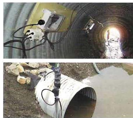
Figure 7 : Instrumentation de deux ponceaux à Beaver Creek (a) et à proximité de la frontière de l'Alaska (b) sur la route de l'Alaska, Yukon. Sources : Loriane Perier, Université Laval et Benoît Loranger, Université Laval
