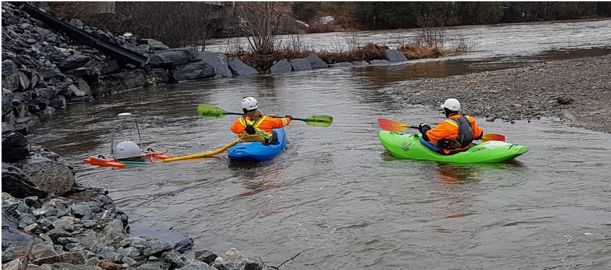
Figure 6 : HydroBall® et un GNSS-RTK installés sur un trimaran
