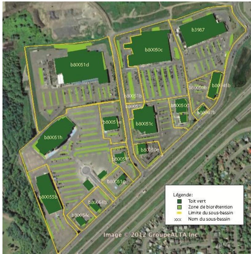
Figure 26 : Implantation de toits verts extensifs et d'îlots de biorétention dans le secteur commercial. Image aux fins d'illustration seulement car elle n'est pas à l'échelle. Voir la figure 25 pour l'orientation de chaque zone.
