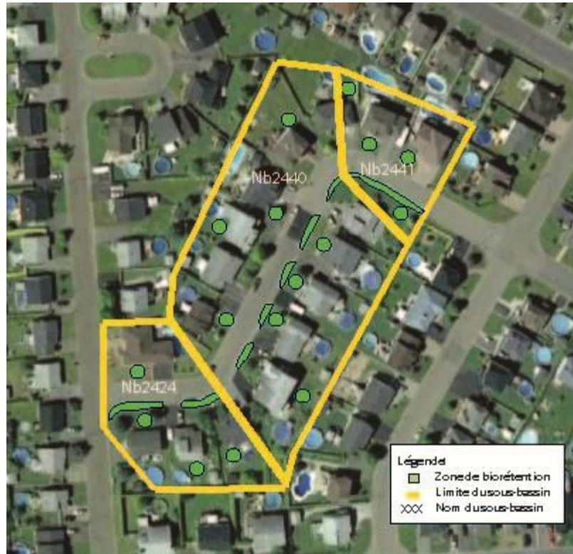
Figure 27 : Implantation de zones de biorétention dans le secteur résidentiel. Image aux fins d'illustration seulement, n'est pas à l'échelle. Voir la figure 25 pour l'orientation de chaque zone.
