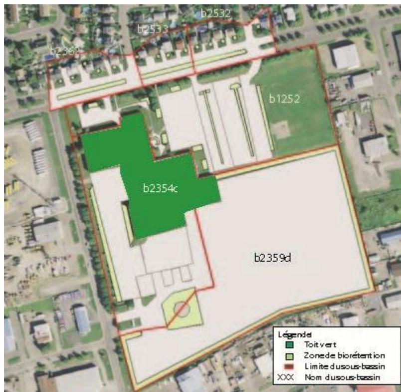
Figure 28 : Implantation de toits verts et de zones de biorétention dans le secteur industriel. Image aux fins d'illustration seulement, car elle n'est pas à l'échelle. Voir la figure 25 pour l'orientation de chaque zone.
