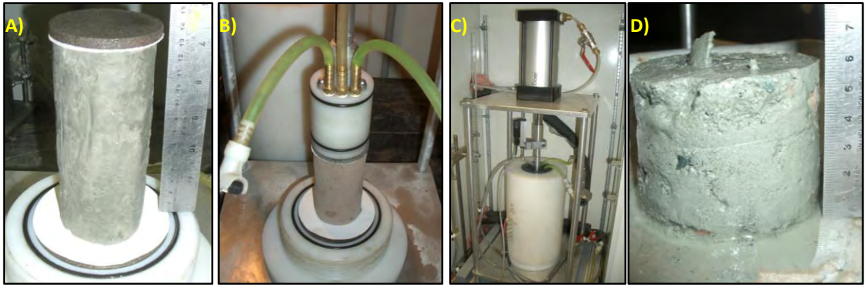
Figure 7 : A) Échantillon posé sur la base de la cellule. B) Piston reposant sur la pierre poreuse et l'échantillon. C) Montage de l'équipement dans une chambre à température contrôlée (+2 °C). D) Échantillon après consolidation au dégel.
