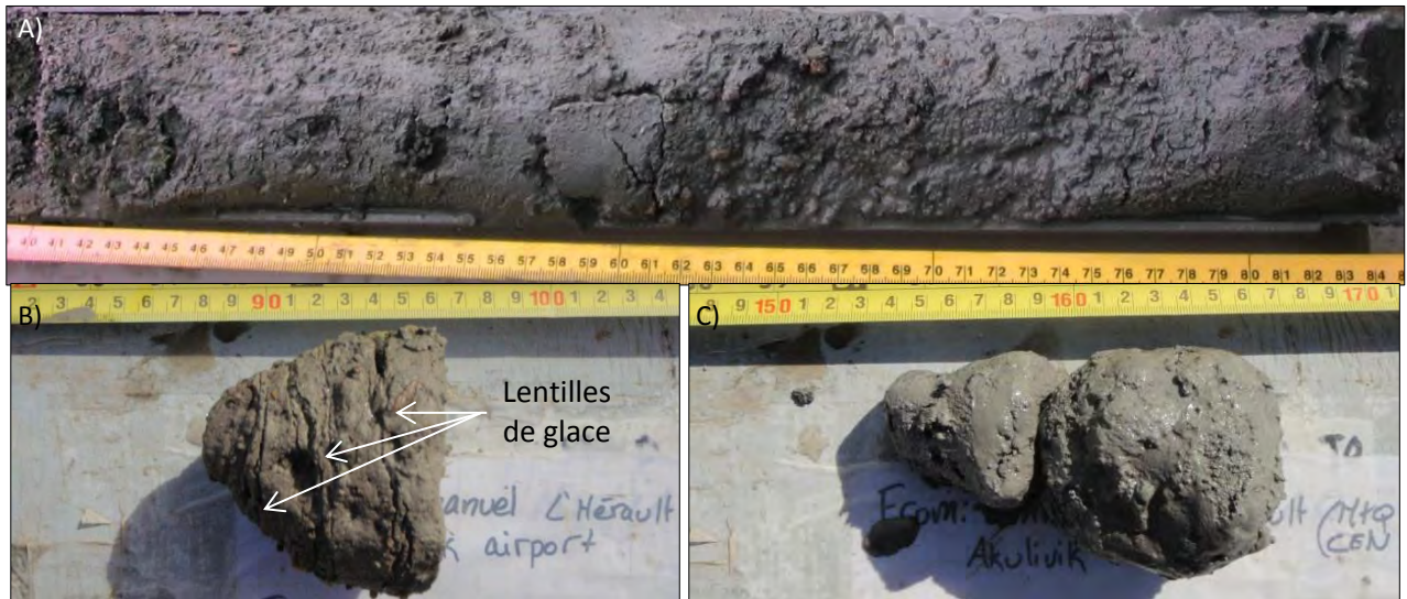
Figure 20: A) Échantillons de till prélevé entre 11,50 et 11,80 m de profondeur sous les sédiments marins fins d'eau profonde lors d'un forage réalisé au fond d'une dépression dans le secteur de l'aéroport (Tirée de L'Hérault et al., 2012). B) Échantillons de till remanié (Tx) prélevé au forage PUV_F4 entre : 0,88 et 0,96 m (B) et 1,54 et 1,67 m (C) de profondeur (Tirée de L'Hérault et al., 2012).
