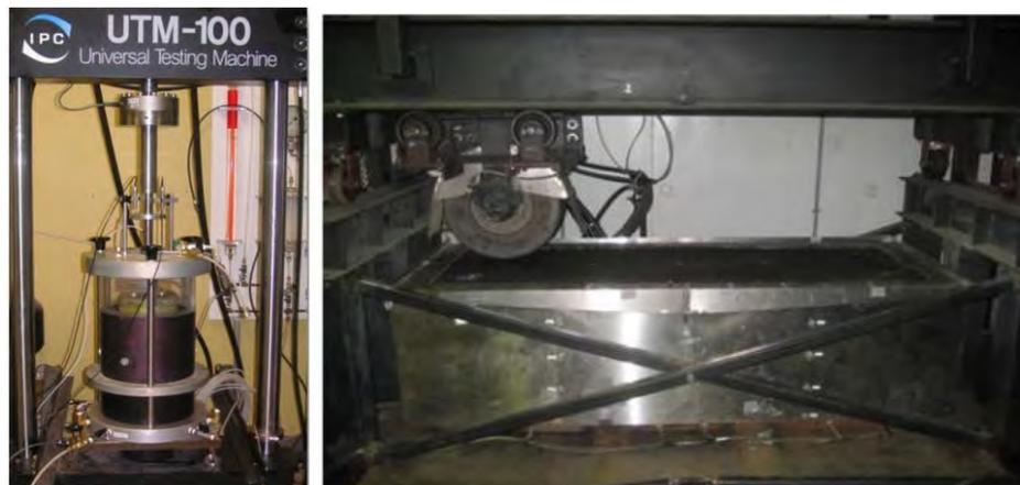
Figure 11. Presse hydraulique UTM-100 pour les essais de module réversible et déformation permanente en cellule triaxiale (Thiam 2014) et simulateur de charge roulante (Poupart 2013)
