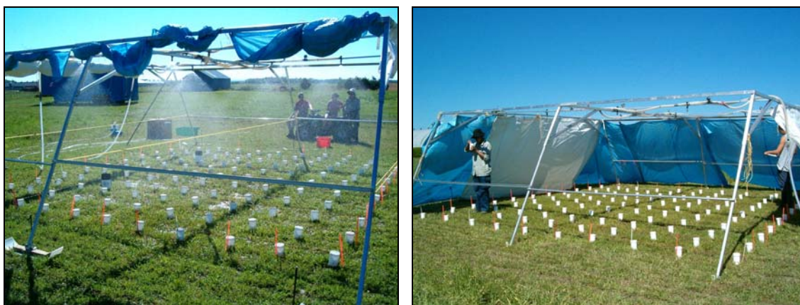
Figure 7.6 : Test d'intensité de pluie et mesure des hauteurs d'eau.
