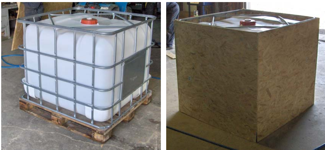
Figure M.4 : Confection des réservoirs utilisés pour la collecte des eaux de ruissellement
