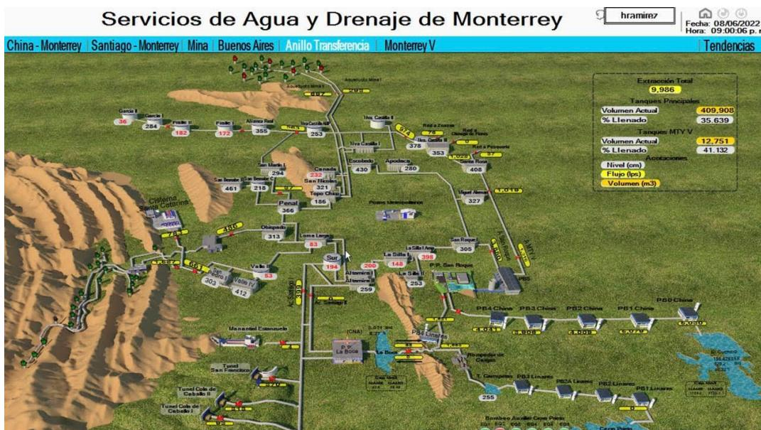
Figure 5.3 Écran de contrôle des éléments des réseaux d'eau potable et d'égout de SADM
