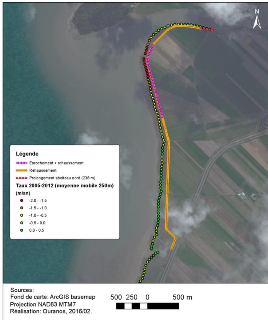
**Figure 4.1** – Enrochement et rehaussement de l'aboteau
