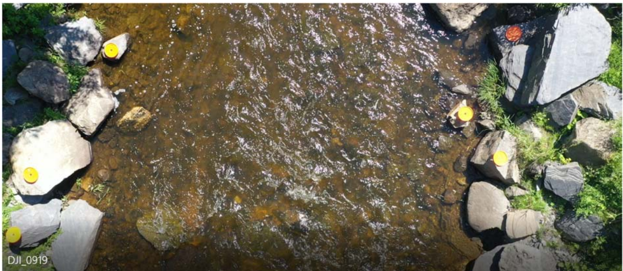
Figure 6. Disposition des cibles lors de l'enregistrement des vidéos par caméra à partir du pont
