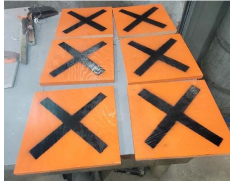
Figure 2. Exemple de cibles utilisées comme points de référence
