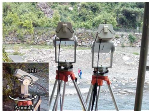
Figure 9 : Système automatique de calcul du débit composé de deux caméras dans des étuis étanches (Huang et al., 2018)
