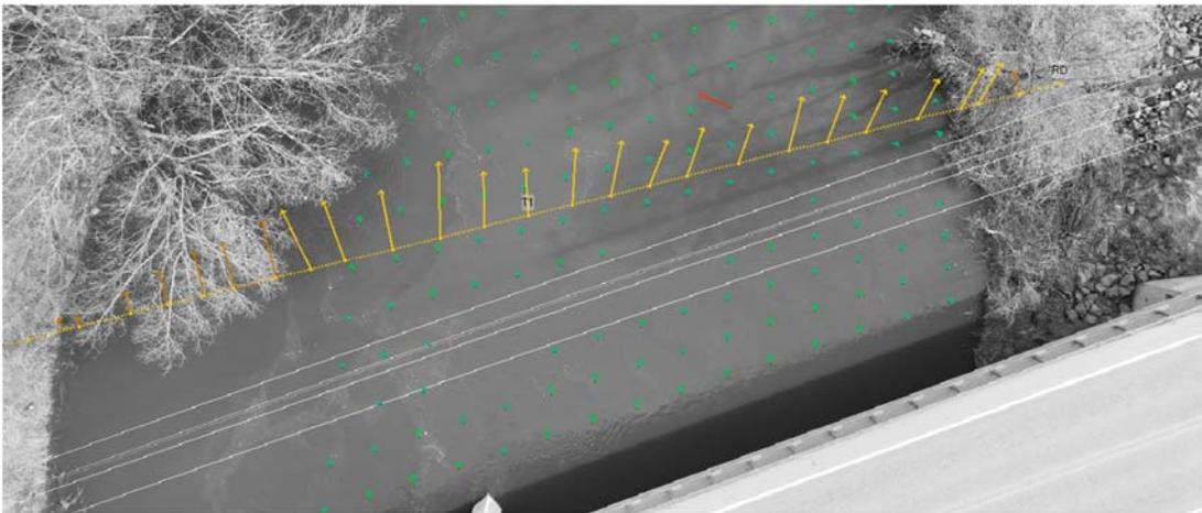
Figure 27 : Interpolation des vitesses (flèches orange) sous les arbres et vecteurs de vitesse absents sous les fils électriques sur la rivière Massawippi
